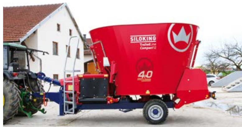
Поперечный транспортер спереди и разгрузочная заслонка сзади по центру.
