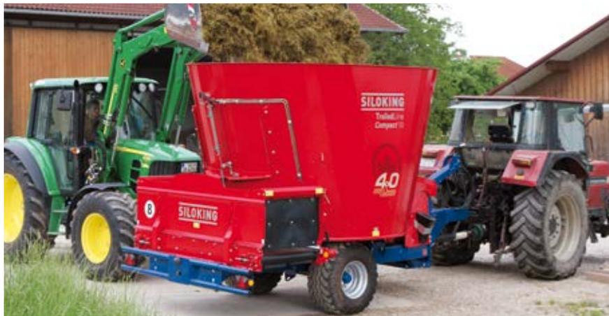
Стабильный защитный брус с интегрированным освещением обеспечивает безопасность для людей, животных и машины днем и ночью.
