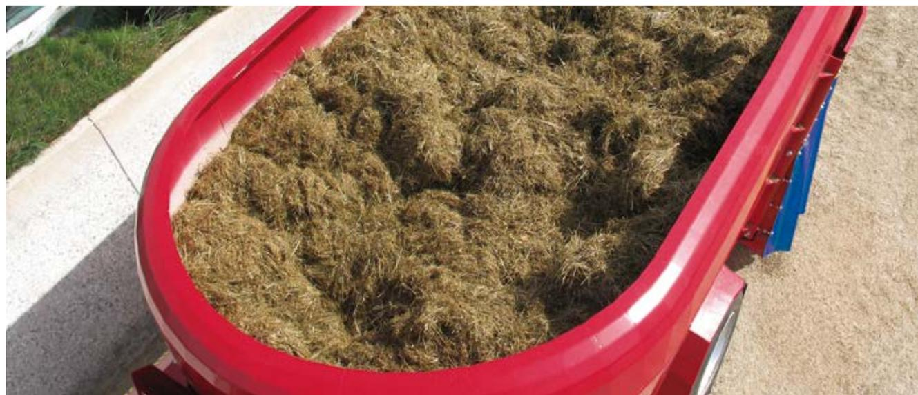
Закругленный край бункера FlowPlus обеспечивает движение корма сверху вниз и гарантирует бесперебойность процесса даже при работе с рулонами.
