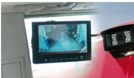
Камера заднего вида и монитор широкого разрешения.
