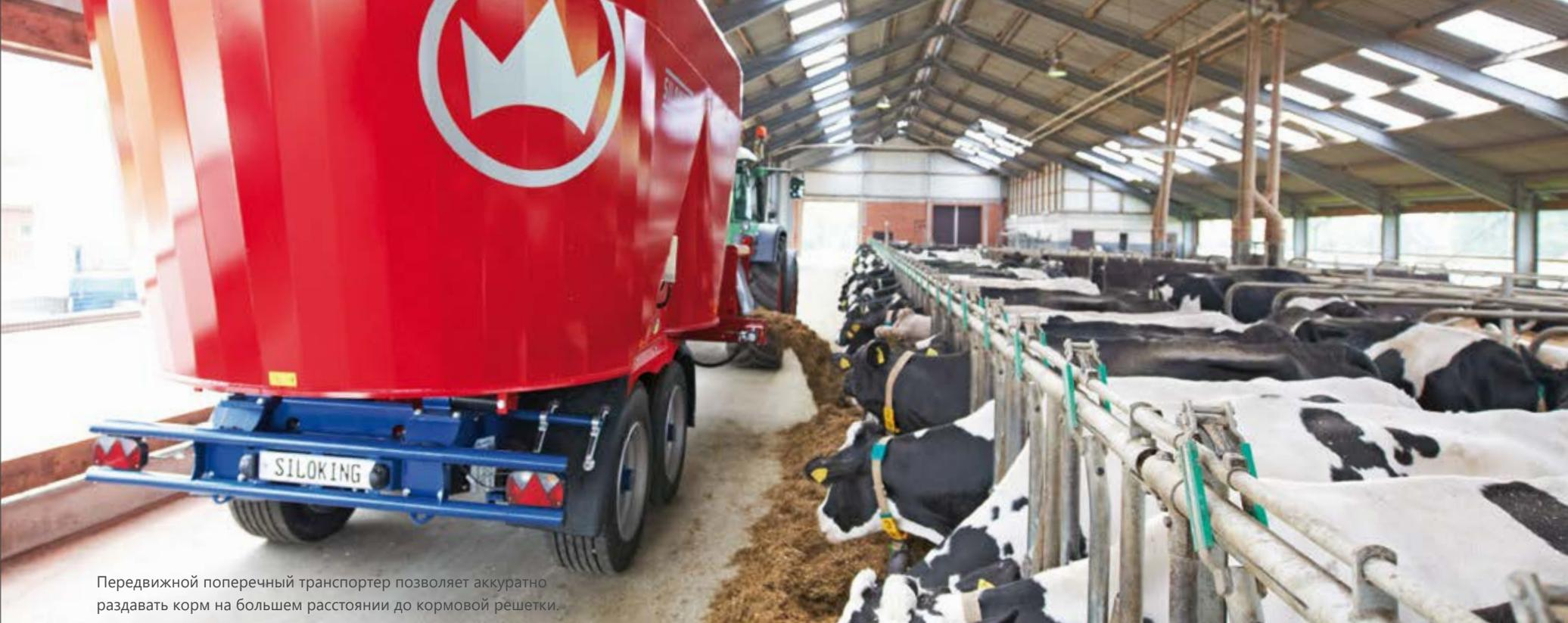
Передвижной поперечный транспортер позволяет аккуратно раздавать корм на большем расстоянии до кормовой решетки.
