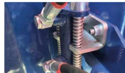
Гидравлический переключатель коробки передач.
