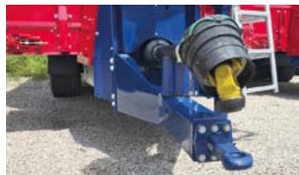
Карданный вал с большим углом действия и дышло сцепления снизу.
